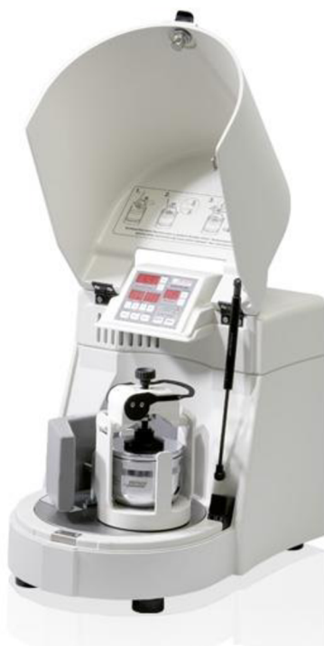
Obr. 18 Planetový mlýn Pulverisette 6 Fritsch zdroj: https://www.ilabo.cz/firmy/fritsch-vyhradni-zastoupeni-v-cr/laboratorni-mlyny/mlyny-planetove/prodej-laboratorni-techniky-planetovy-mlynek-pulverisette-6-fritsch/
