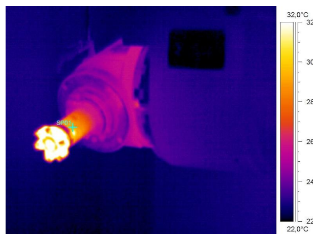
Obr.1.3 Termosnímek nástroje a jím ovlivněné vřeteno [7]
