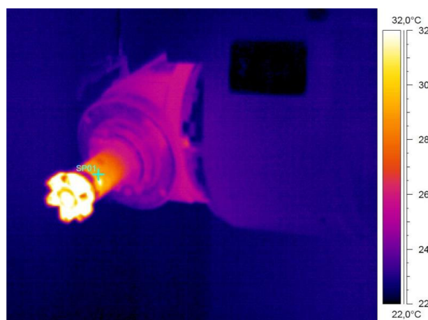
Obr.1.3 Termosnímek nástroje a jím ovlivněné vřeteno [7]
