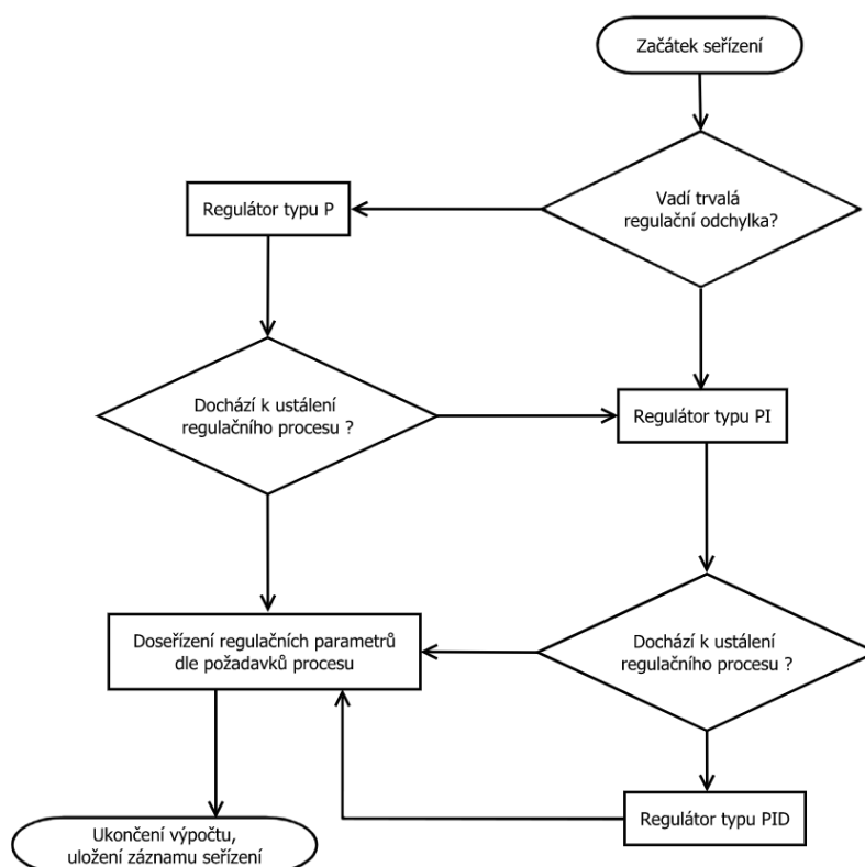
Obr. 3.16 Diagram seřizování PID regulátoru
