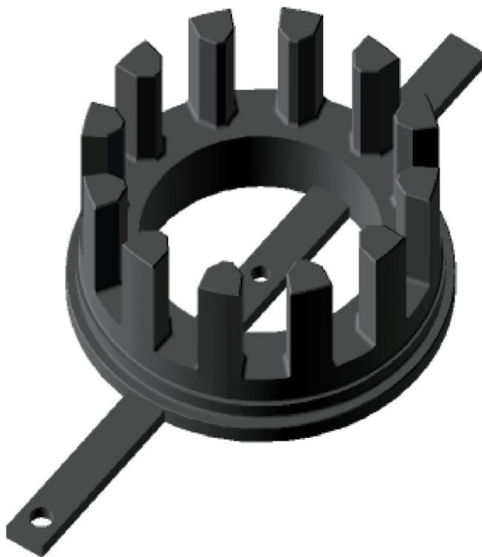
Obr. 6.1 Sestava nové konstrukce věnce hydraulického válce
