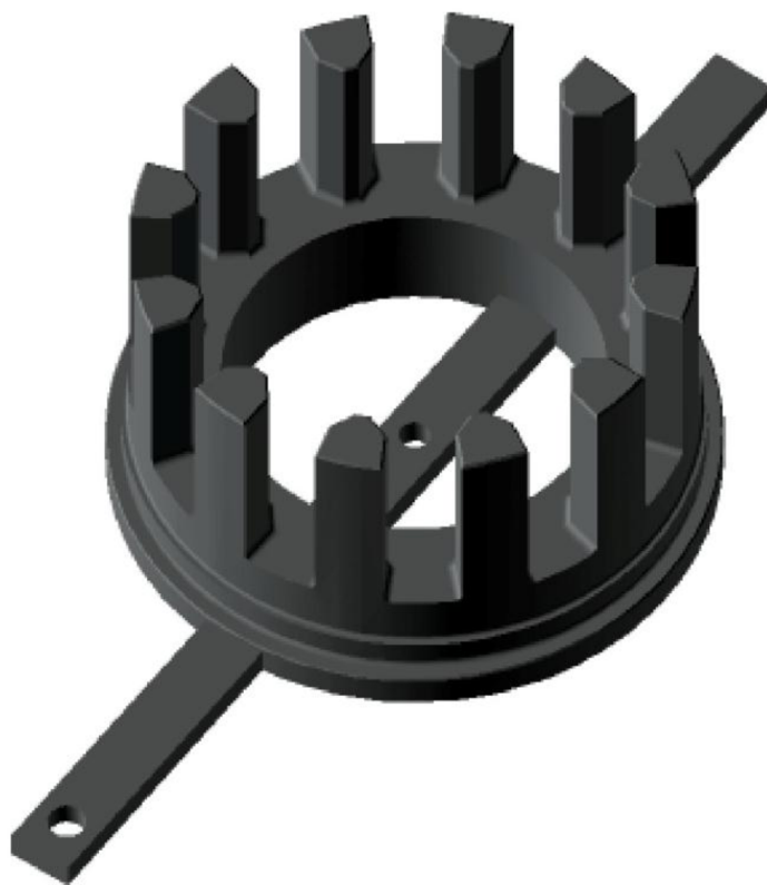
Obr. 6.1 Sestava nové konstrukce věnce hydraulického válce
