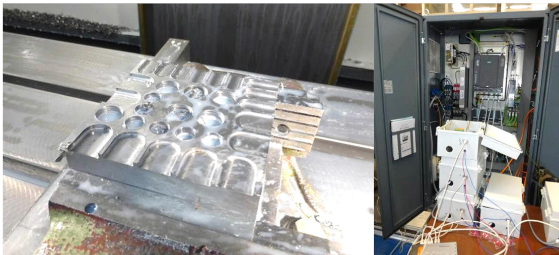
Obr. 3.10 Obrobek a měření příkonu testovací cyklu na demonstrátoru
