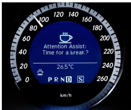
Obr. 5 Asistent pozornosti s doporučením na přestávku [10]
