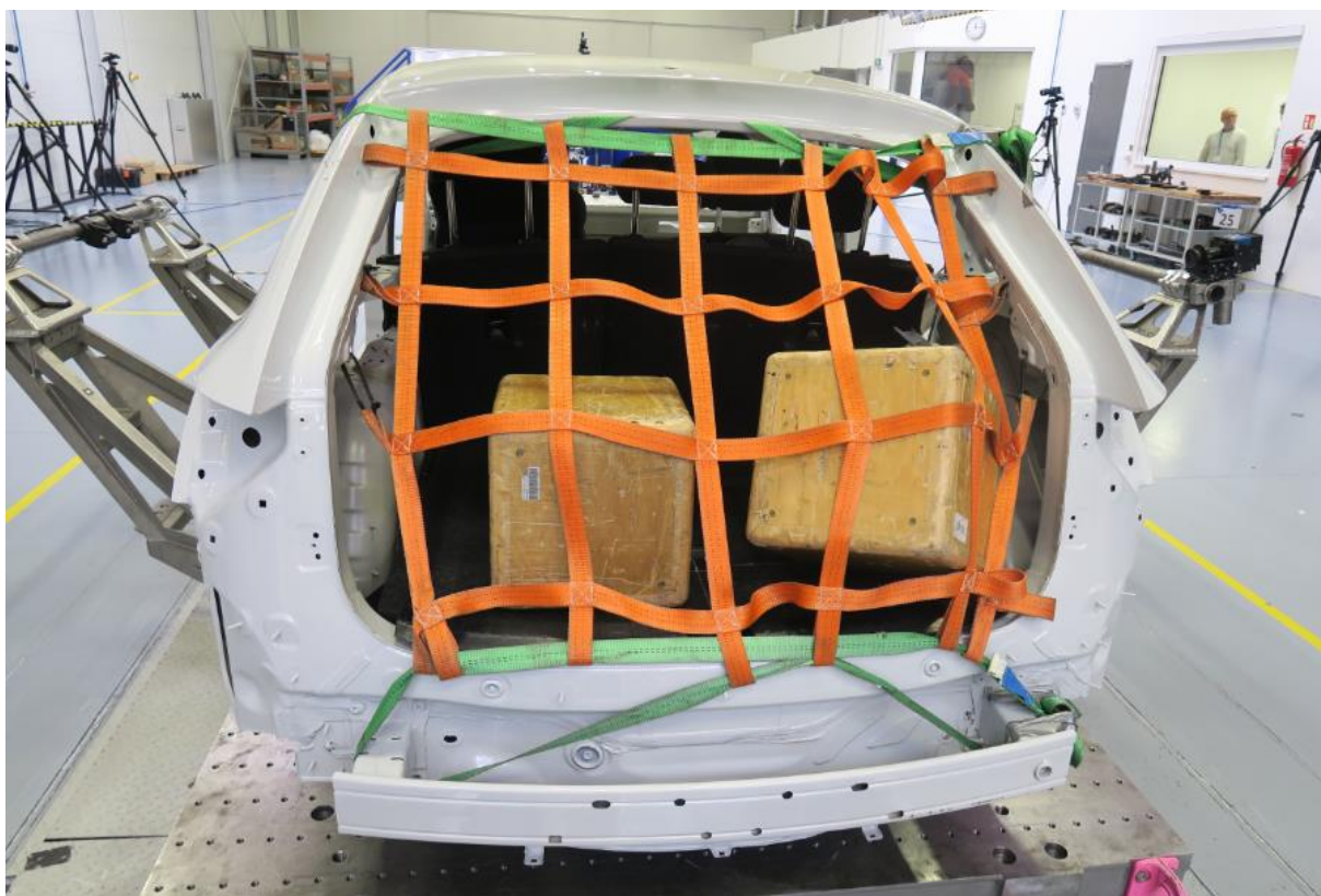
Obrázek 5 Zabezpečení před vypadnutím impaktorů ze zavazadlového prostoru
