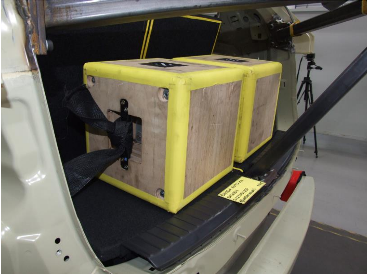
Obrázek 2 Zkušební impaktory v zavazadlovém prostoru
