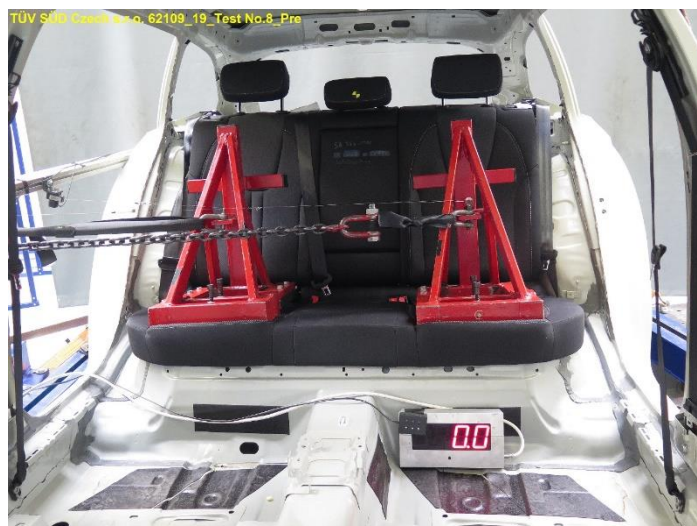
Obr. 45 Zkouška silou šikmým směrem
