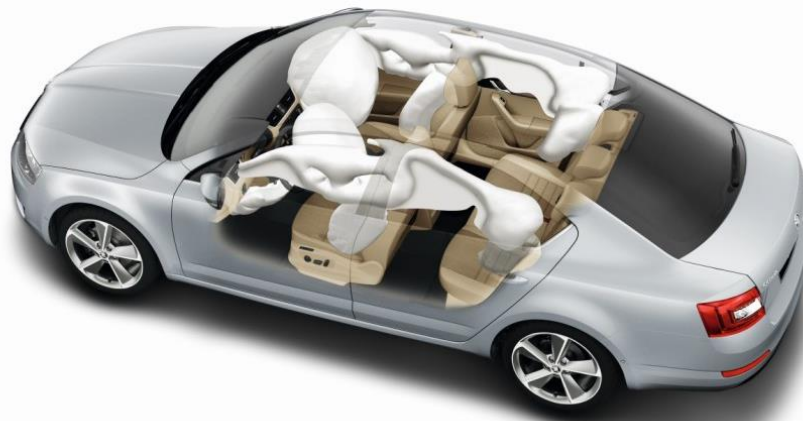
Obr. 16 Znáznornění umístění airbagů ve voze [24]
