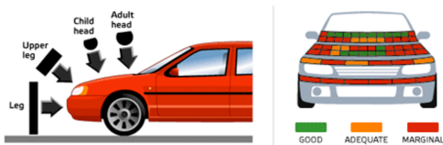
Obr. 26 Ukázka zón s impaktorem u vyšší a střední třídy vozu [31]
