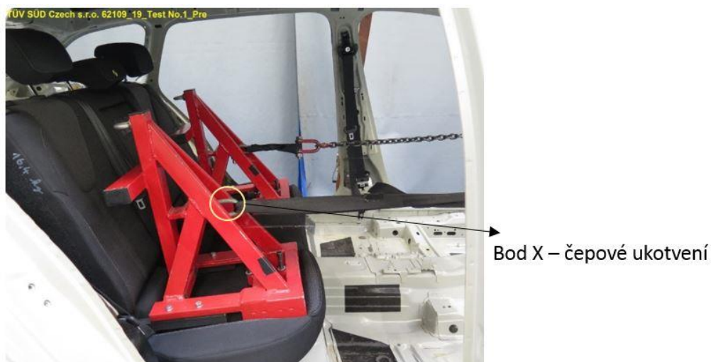
Obr. 44 Zkouška silou směrem dopředu
