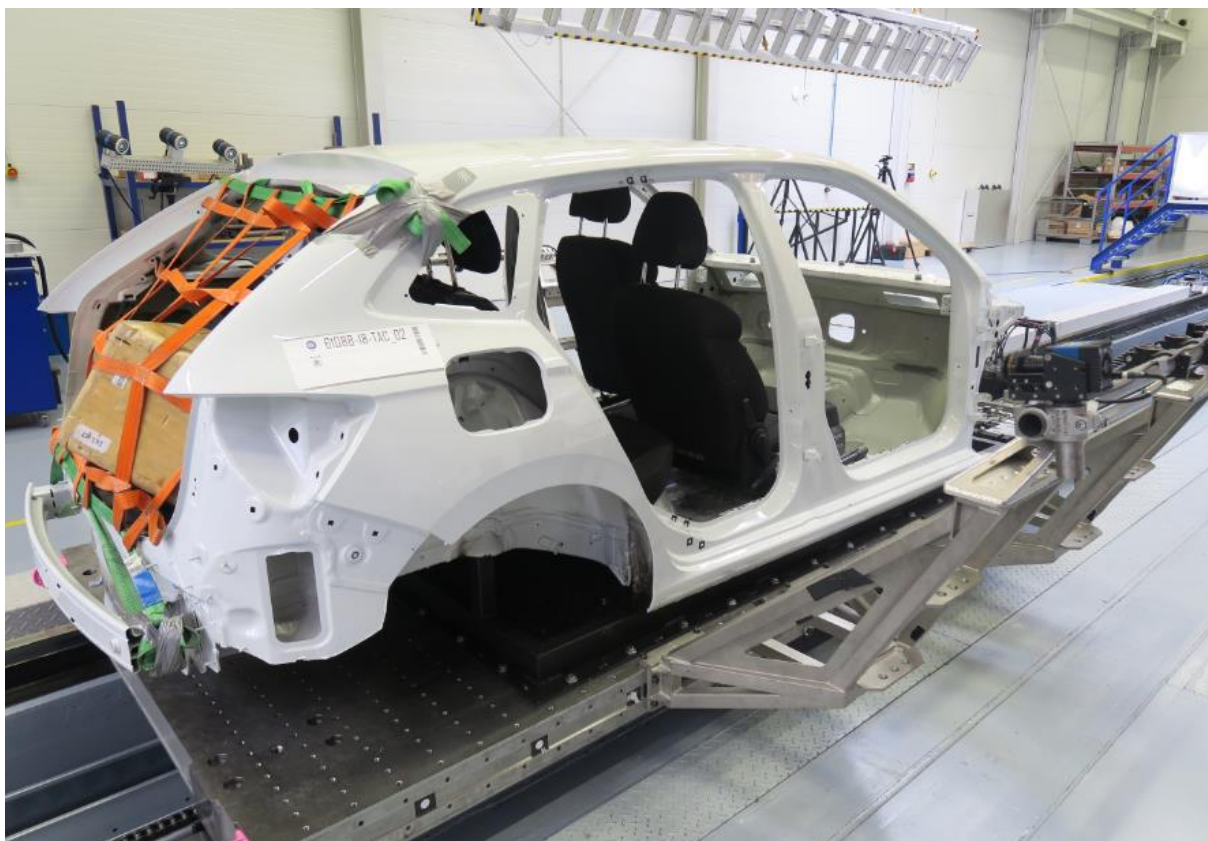
Obrázek 4 Karoserie vozu po zkoušce
