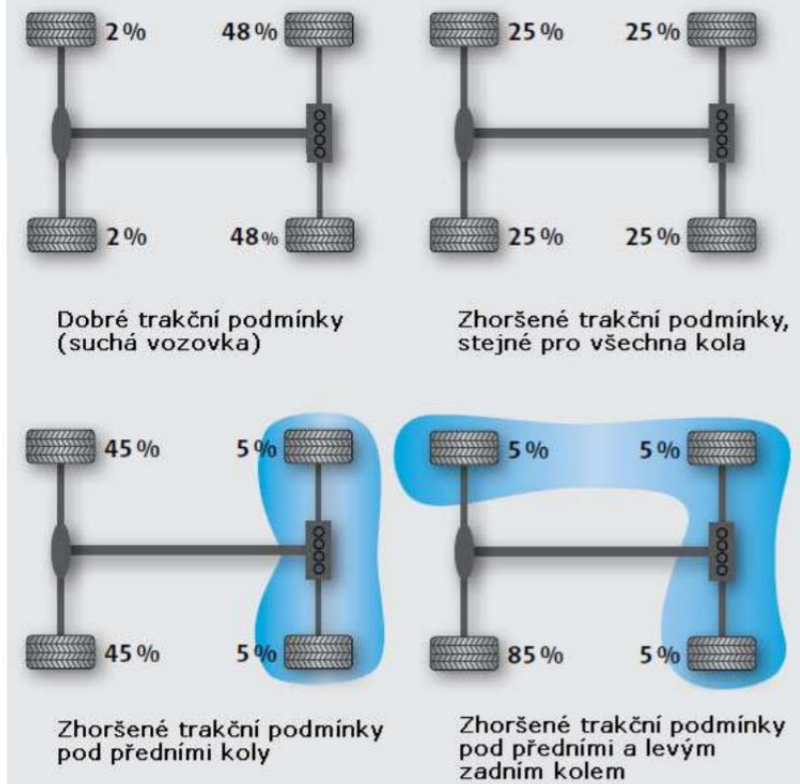
Obr. 8 Rozdělení točivého momentu mezi jednotlivá kola [12]
