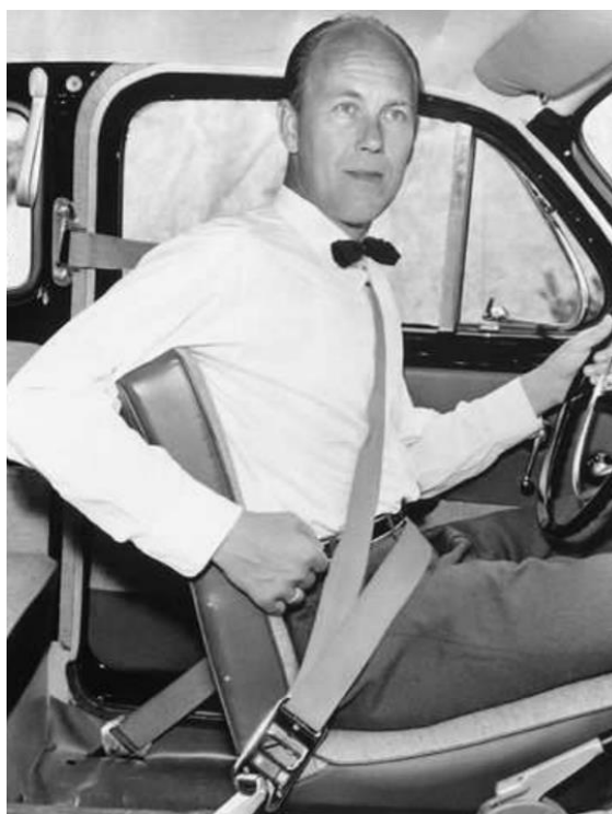
Obr. 2 První bezpečnostní tříbodový pás ve vozech Volvo [4]
