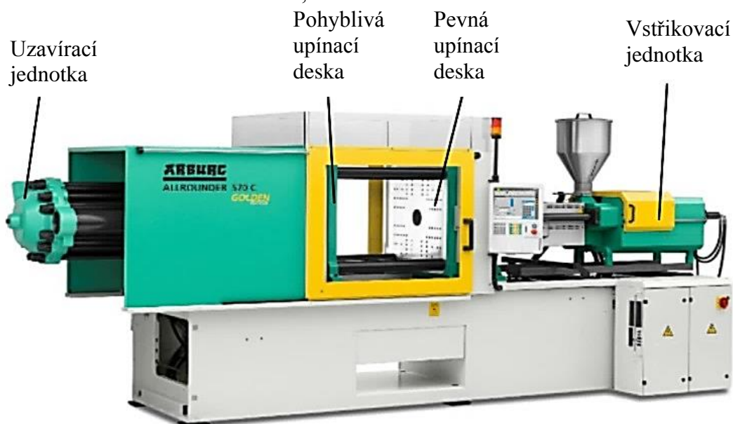
Obr. 48 Vstřikovací stroj [15], [28]
