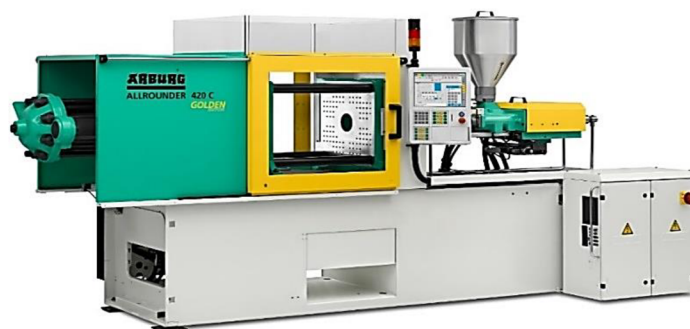
Obr. 93 Vstřikovací stroj Arburg Allrounder 420 C [59]
