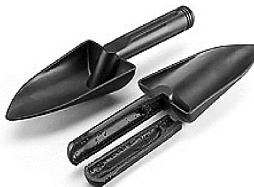
Obr. 44 Vstřikování s podporou plynu [20]
