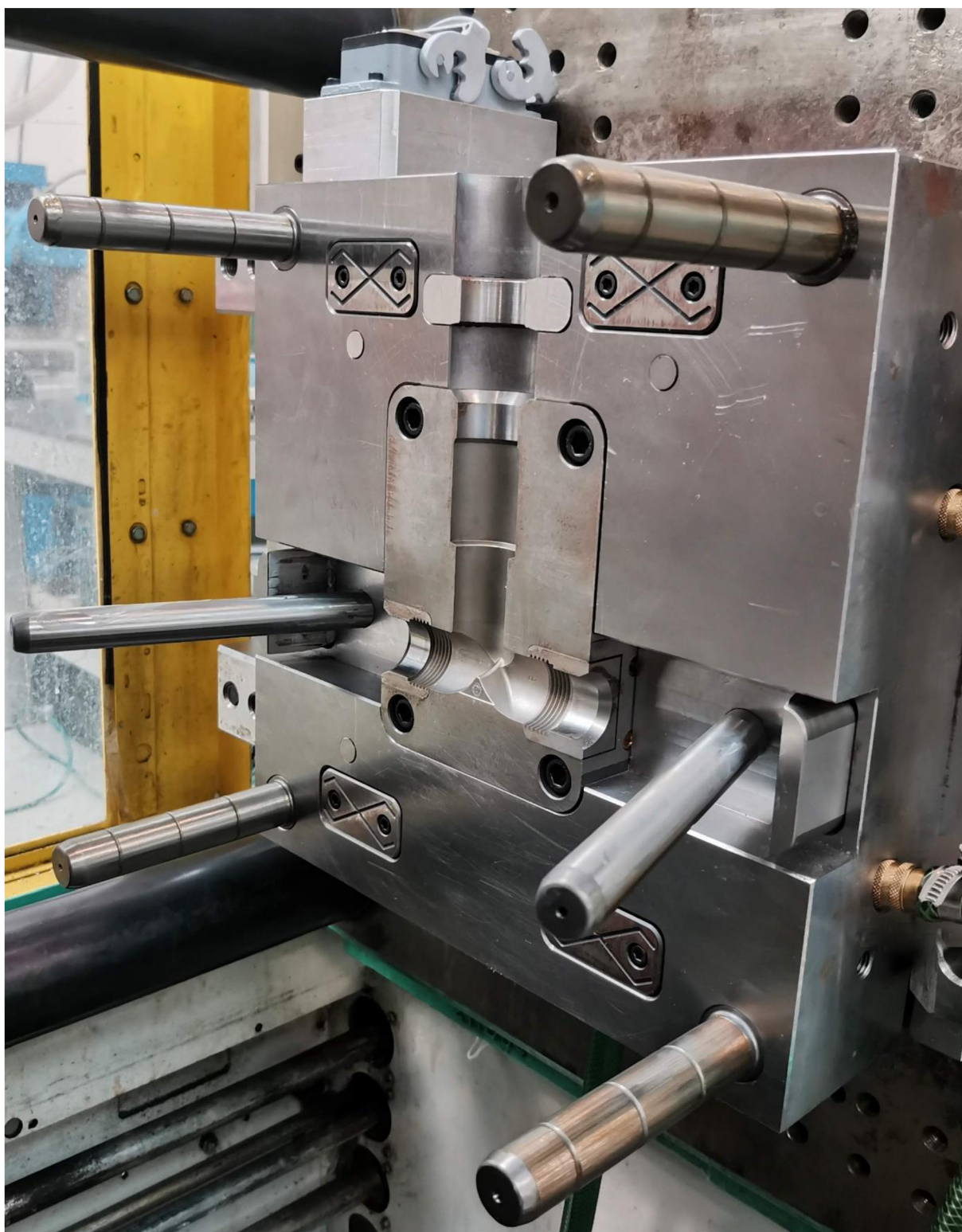
Příloha 17 Upnutí vstříkovací formy na lis – pevná polovina
