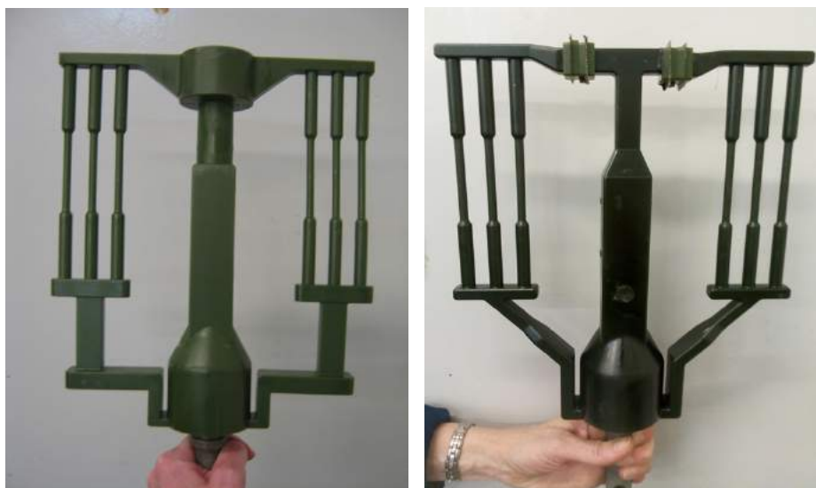
Obr. 43 Původní voskový model (vlevo), nový voskový model (vpravo)
