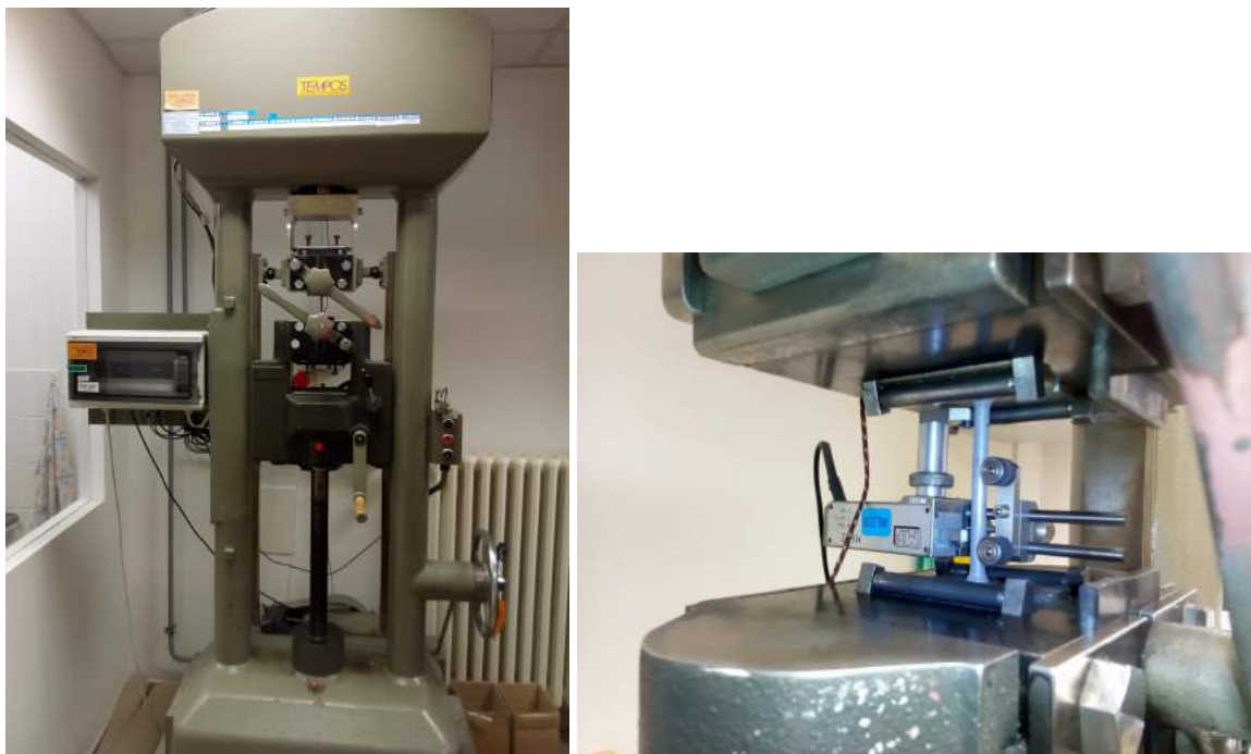
Obr. 53 Trhací stroj ZDM 10/90 (vlevo), umístění průtahoměru mini MFA 2 (vpravo)
