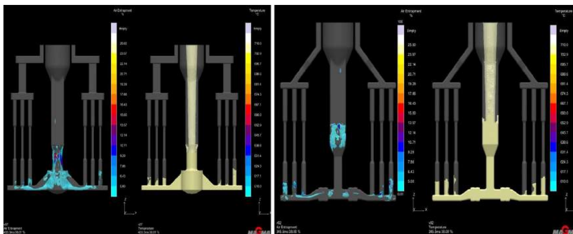
Obr. 42 Zahlčený vzduch v obou variantách vtokové soustavy
