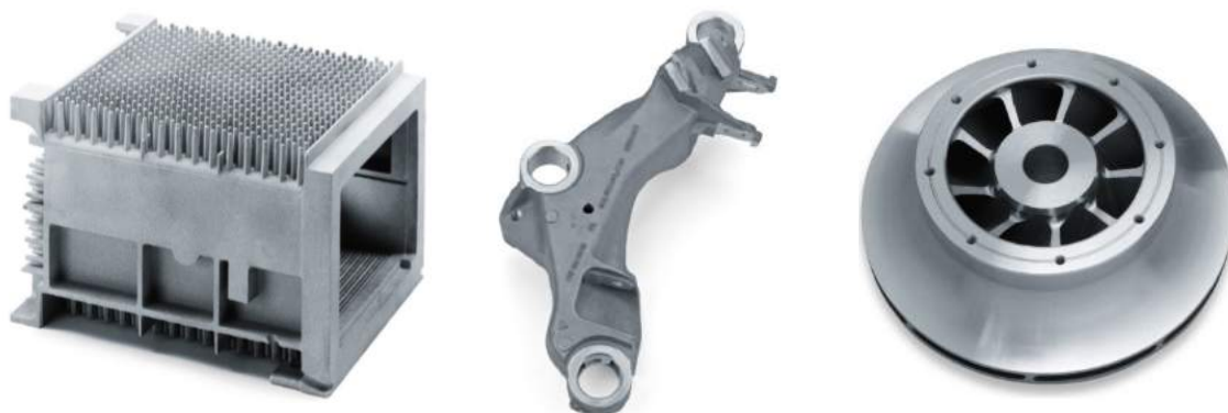
Obr. 16 Odlitky ze slitin typu AlSi7Mg0,3 [33]
