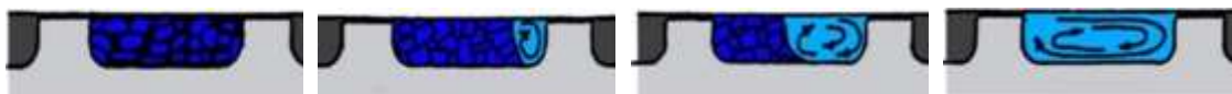
Obr. 2.10 Postupné tavení granulátu [35] zleva: granulát v dopravní zóně; začátek komprese; zvysující se podíl taveniny; homogenizace taveniny
