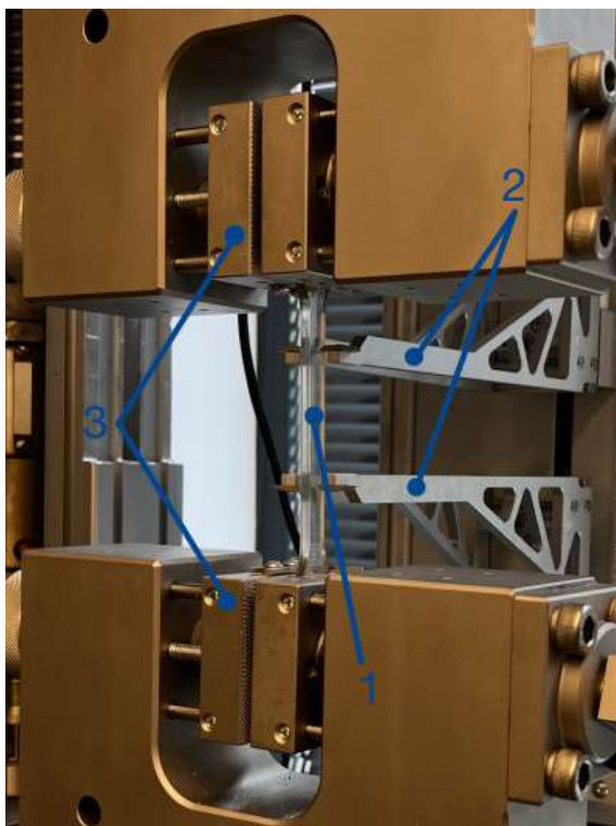
Obr. 3.6 Statická zkouška tahem 1 – zkušební vzorek, 2 – průtahoměr, 3 – pneumatické čelisti
