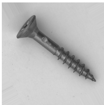
(b) Poškozený krček
