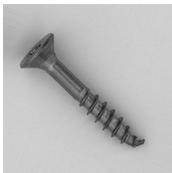
(a) Poškozená špička
