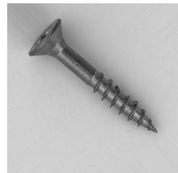
(c) Poškozený závit
