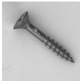
(b) Poškozený krček
