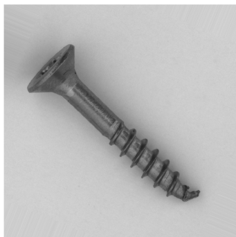
(a) Poškozená špička
