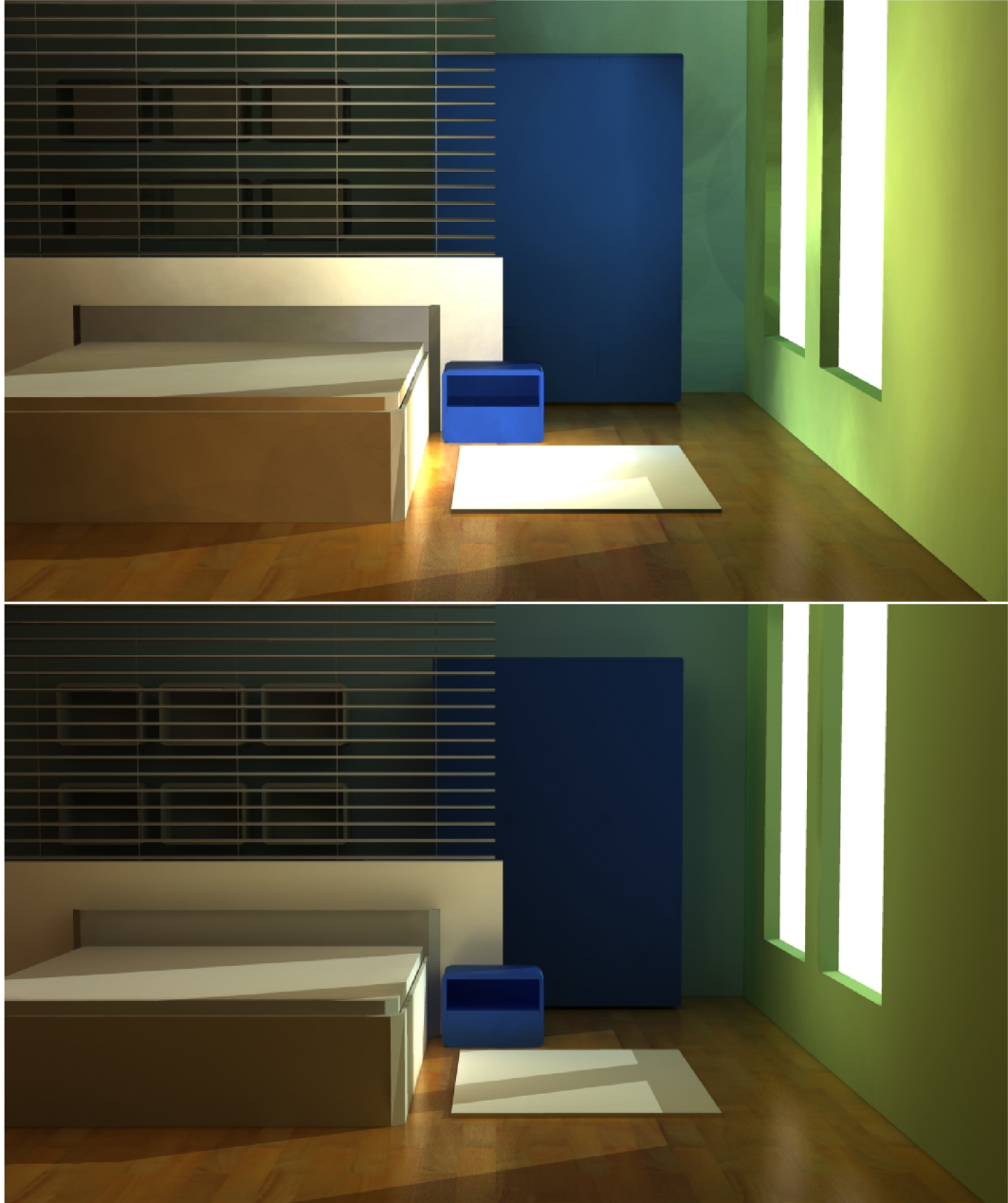
Obrázek 3.9: Obrázky vyrenderované pomocí photon mapping, nahoře bez final gathering, dole s final gathering. Na horním obrázku lze vidět artefakty po photon mapě , zejména v rohu místnosti.
