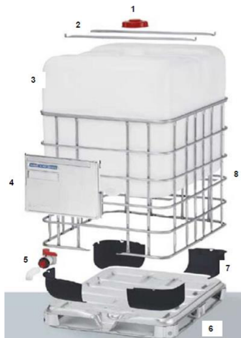
Obrázek 6 IBC kontejner Schütz [15]; 1- víko, 2- vzpěry, 3- nádoba, 4 identifikační deska, 5-vypouštěcí kohout, 6- paleta, 7- ochranné rohy, 8- klec
