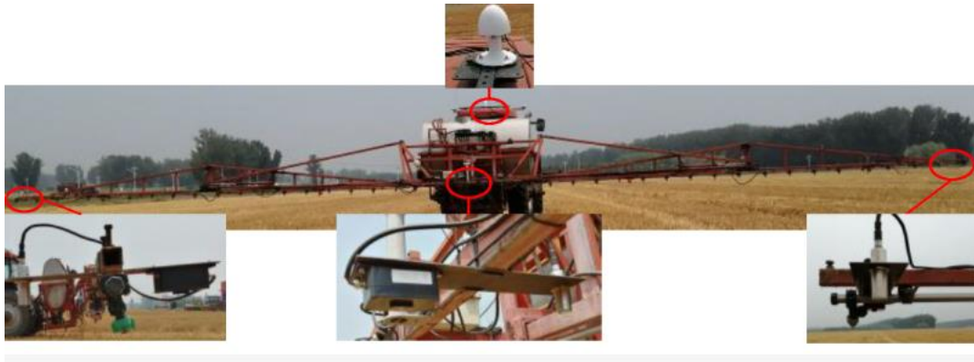
Obr. č.: 24 Znárodnění umístění senzorů LiDAR na rampě postřikovače spolu s kombinací s navigací stroje (zdroj: https://www.mdpi.com 2022)
