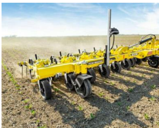
Obr. č.: 25 LiDAR senzor v kombinaci s naváděcí kamerou na řádek (zdroj: https://www.bednar.com 2022)
