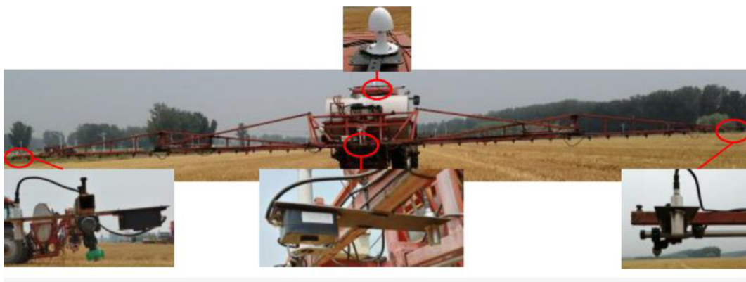
Obr. č.: 24 Znárodnění umístění senzorů LiDAR na rampě postřikovače spolu s kombinací s navigací stroje (zdroj: https://www.mdpi.com 2022)
