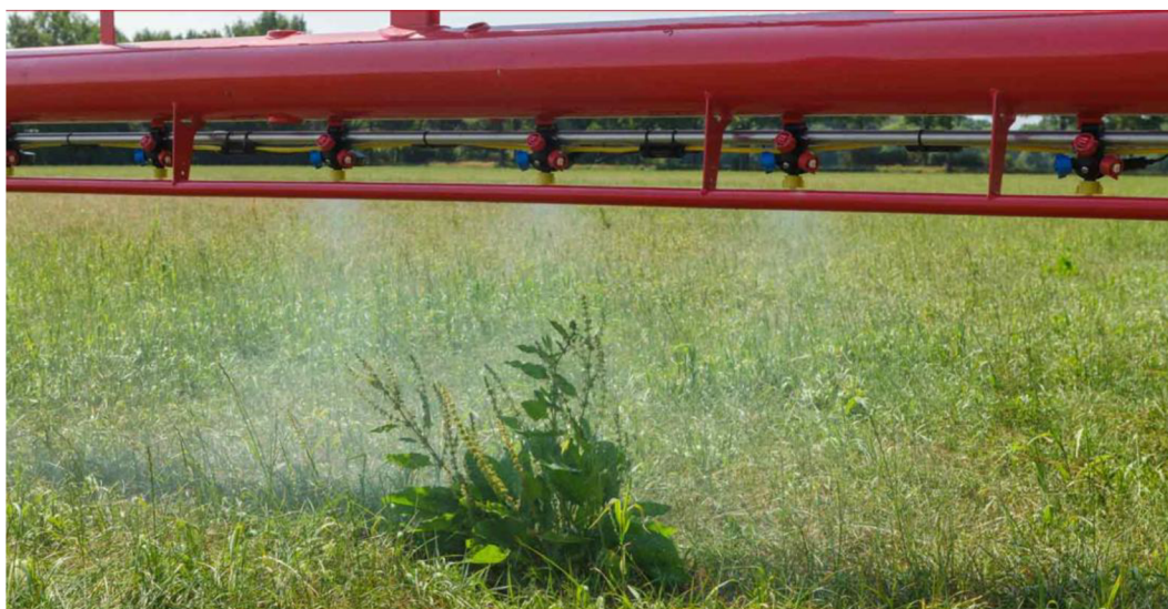
Obr. č.: 6 Cílená aplikace herbicidu pouze na plevel (zdroj: https://www.agrifac.com )
