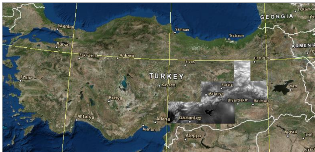
Obrázek 7: Data WorldDEM v souřadnicovém systému WGS UTM zone 37N
