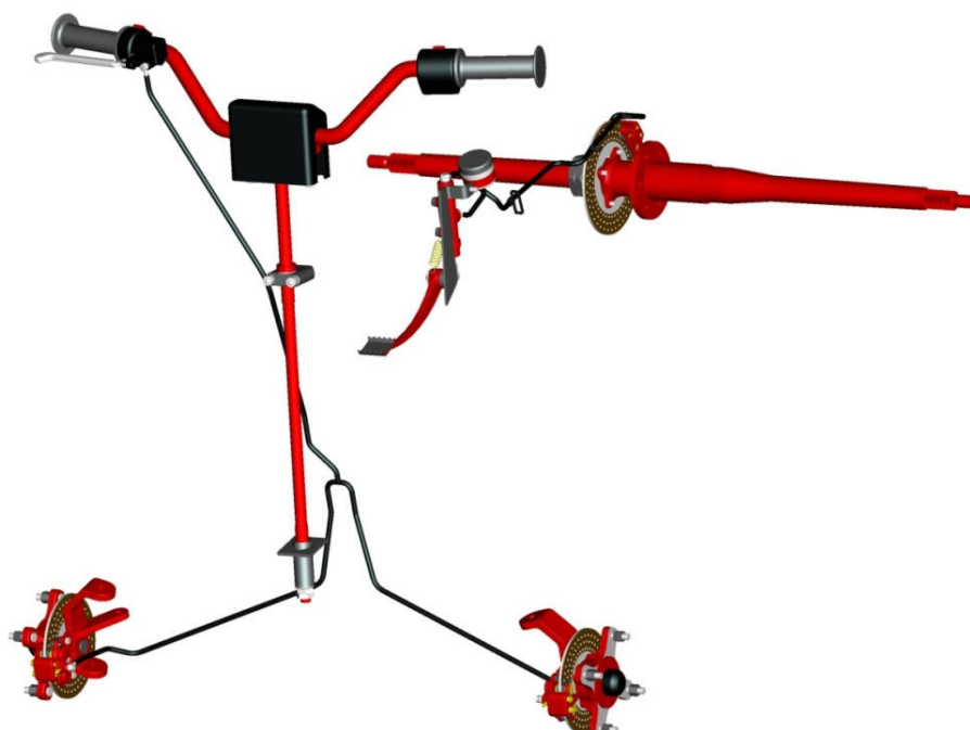
Obr. 77 Přední a zadní brzdový okruh
