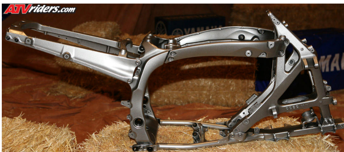
Obr. 9 Rám z hliníkové slitiny [23]
