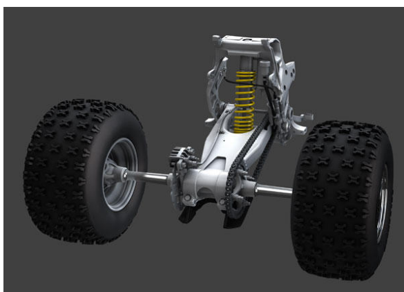
Obr. 15 Zadní kliková náprava o jednom rameni [28]
