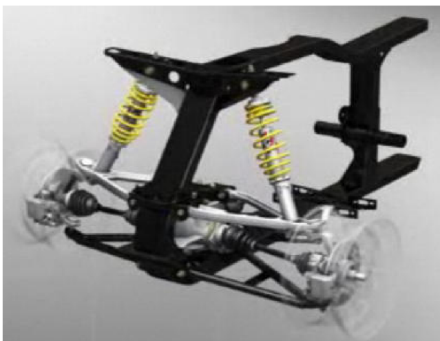
Obr. 10 Rám užitkové čtyřkolky od společnosti Can-Am [31]
