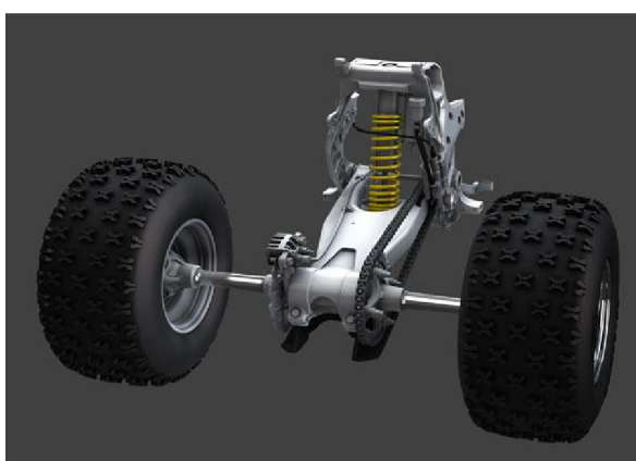
Obr. 15 Zadní kliková náprava o jednom rameni [28]
