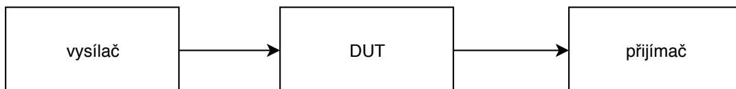
Obr. 2.3: Druhý způsob zapojení. Jedno zařízení vysílá a druhé přijímá rámce, které prochází DUT.[4]
