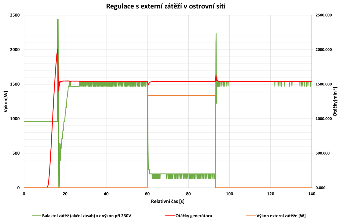
Obr. 11.8: Měřený průběh regulovaných otáček při zatěžování se změnou parametrů PSD regulátoru s PLC
