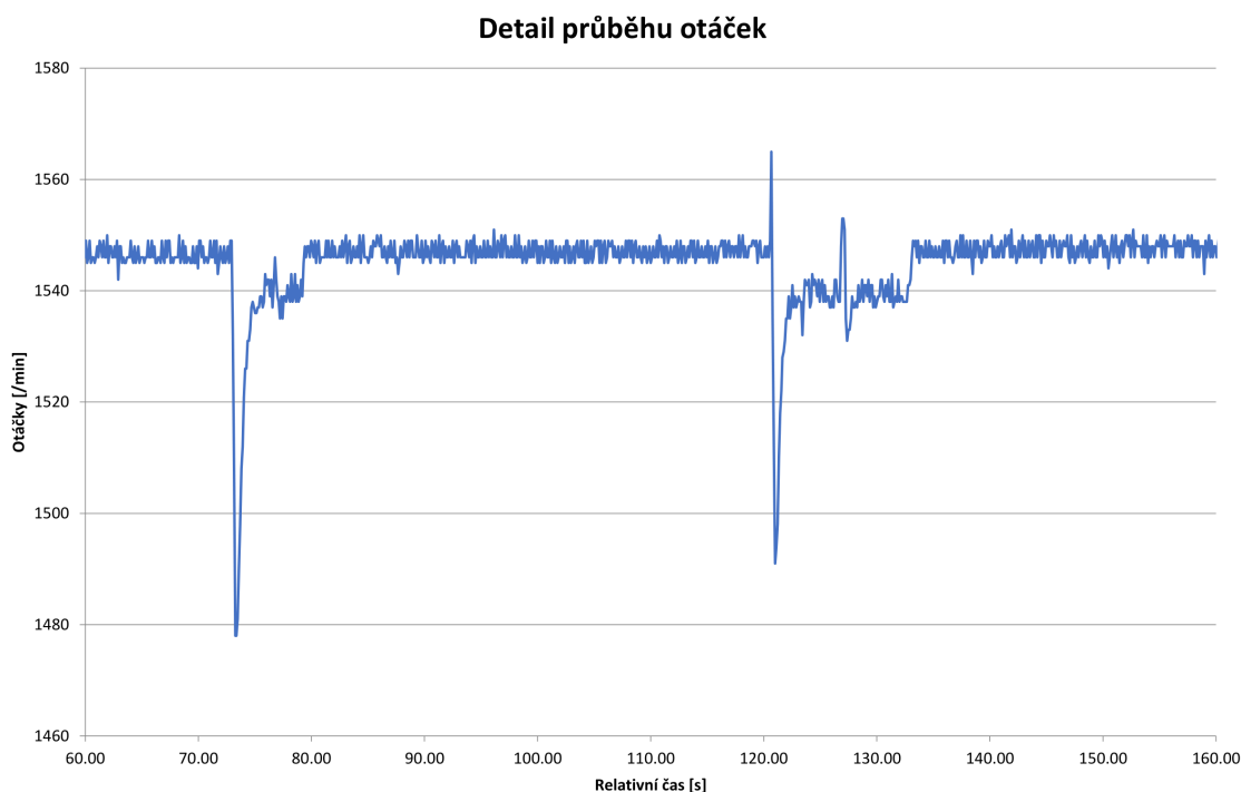
Obr. 11.4: Detail měřeného průběhu regulovaných otáček při zatěžování s potlačením šumu PSD regulátoru
