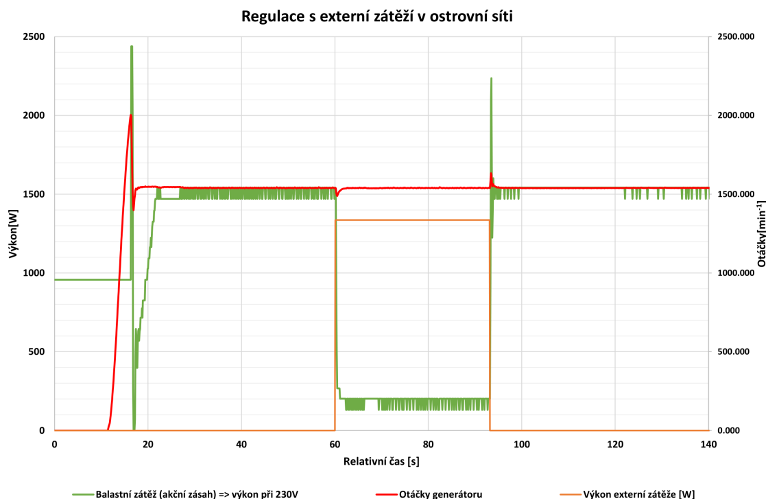
Obr. 11.5: Měřený průběh regulovaných otáček při zatěžování se změnou parametrů PSD regulátoru
