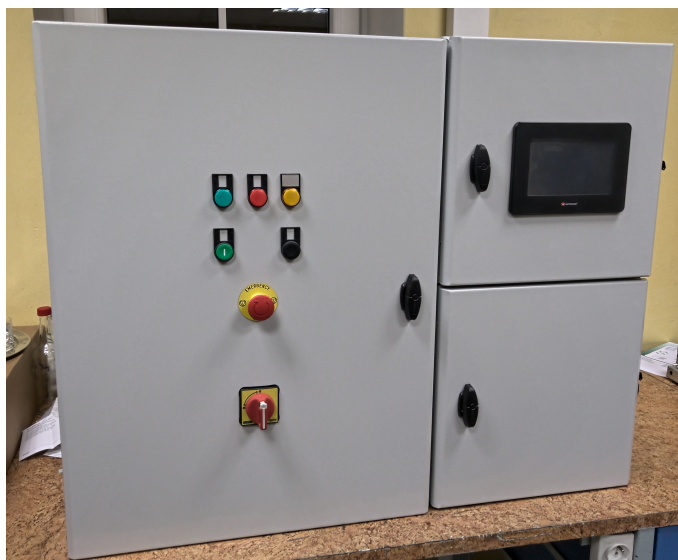
Obr. 5.2: Sestava vyrobených rozvaděčů
