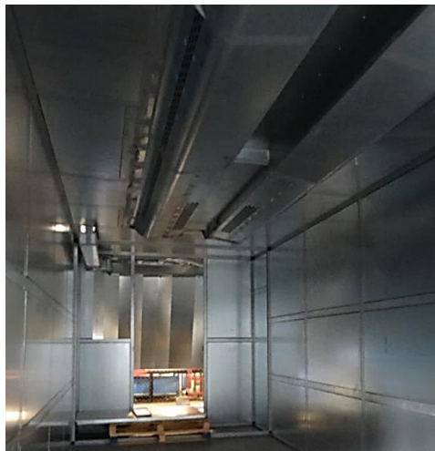
Obr. 10.2 Vzduchové kanály tramvaje ForCity Plus Bratislava
