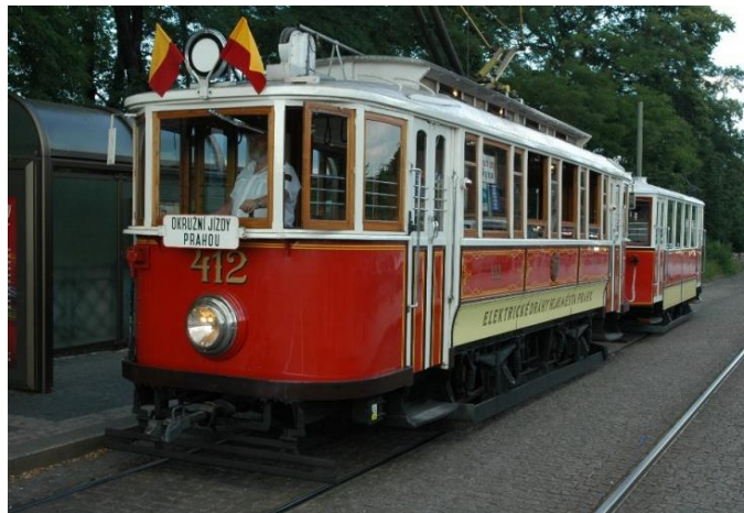
Obr. 8.2 Dvounápravový vůz oboustranný vyráběn v letech 1925-33 [2]
