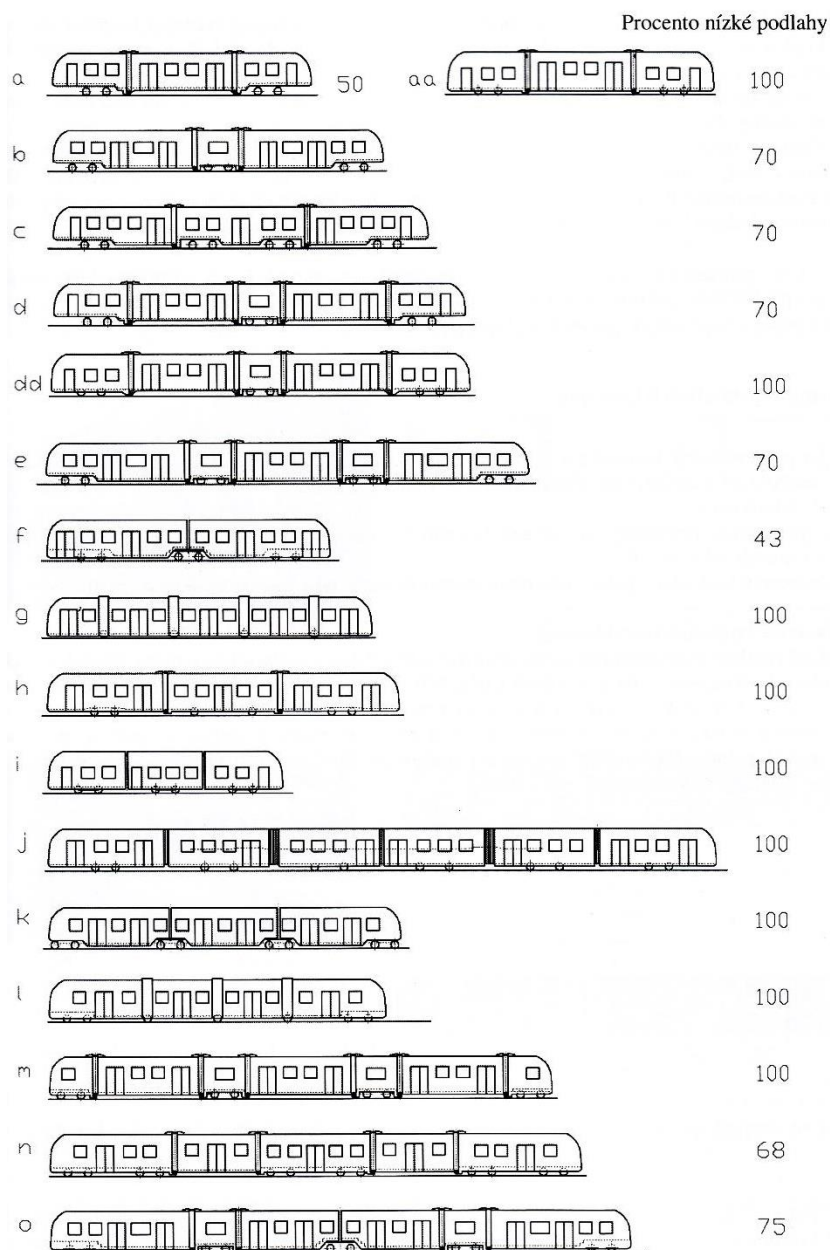
Obr. 8.8 Používané koncepce vícečlánekových tramvají [1]
