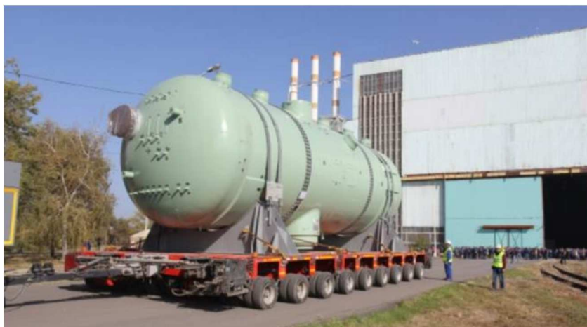
Obrázek 6.3 – Parogenerátor indické elektrárny Kudankulam[52]
