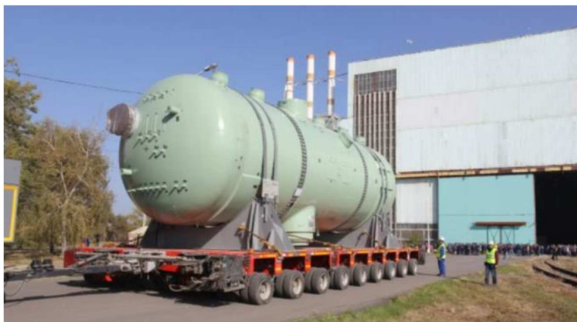
Obrázek 6.3 – Parogenerátor indické elektrárny Kudankulam[52]
