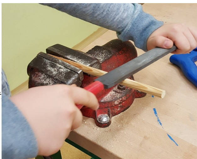
Obr. 58, 59: Vyřezávání a vrtání podstavce. Tyčku z měkkého dřeva o průměru 12 mm si odměřili 110 mm.
