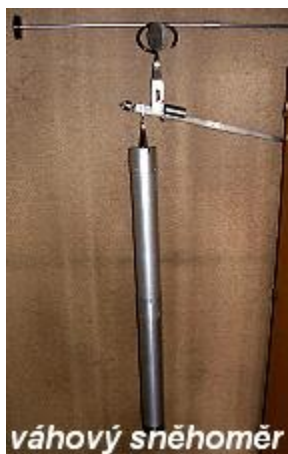
Obrázek 7: Váhový sněhoměr (dle zdroje Meteorologická stanice Marušky – Hostýnské vrchy)
