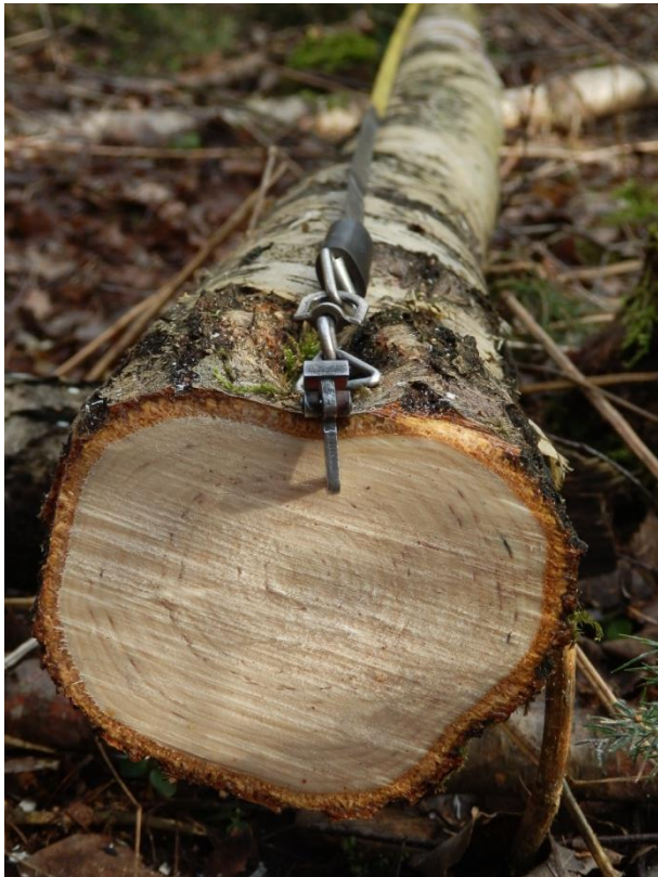
Obr. 12 - Měření vzorníku dřevařským pásmem
