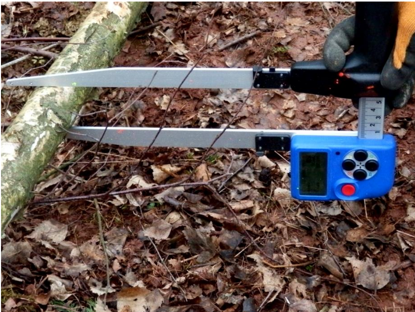
Obr. 11 - Měření digitální průměrkou Mantax
