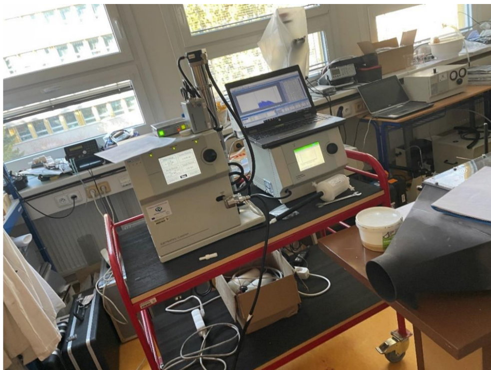
Obrázok 15: prístroj SMPS pri meraní
