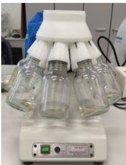
Obrázek 6. Laboratorní dělič vzorků a příklad jednoho vzorku rozděleného na 8 dílů, (Mařátková 2021).
