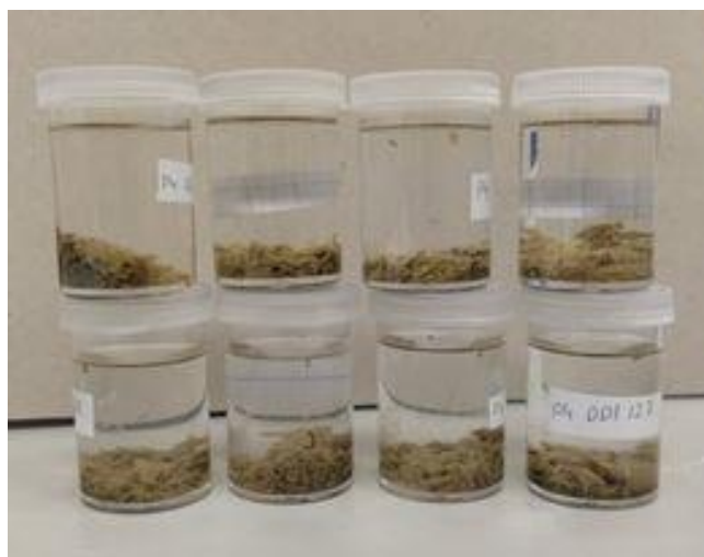
Obrázek 6. Laboratorní dělič vzorků a příklad jednoho vzorku rozděleného na 8 dílů, (Mařátková 2021).
