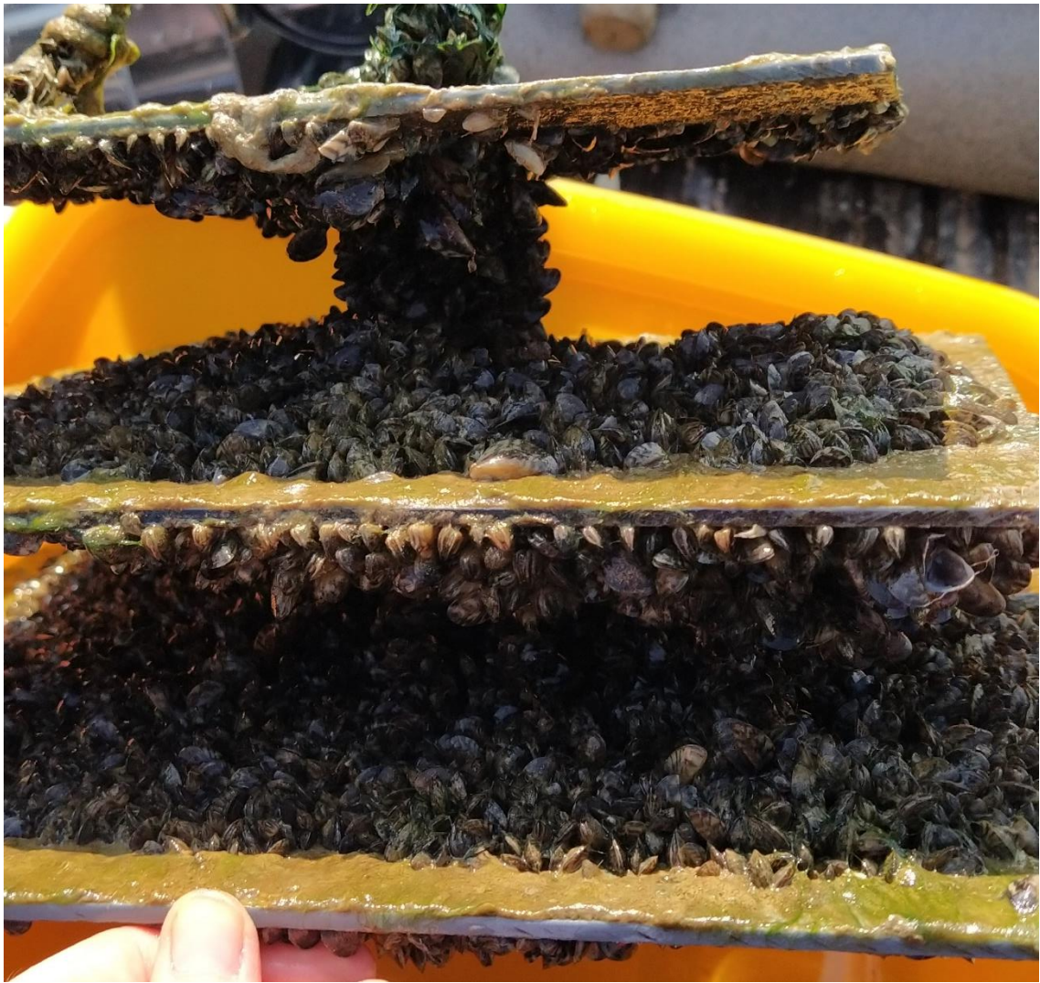
Obrázek 23. Substrátové vzorkovače při odběru vzorků 14.9.2021. Slávičky stále vykazují tendenci obsazovat méně osluněné části desek, (Mařátková 2021).
