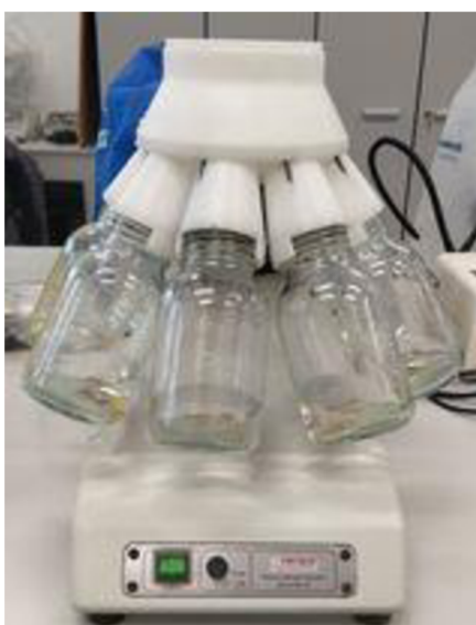
Obrázek 6. Laboratorní dělič vzorků a příklad jednoho vzorku rozděleného na 8 dílů, (Maříátková 2021).
