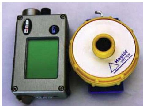
Obr. č. 9 Prístroj VERTEX IV s transpondérom použité pri meraní (Marušák a kol., 2009)
