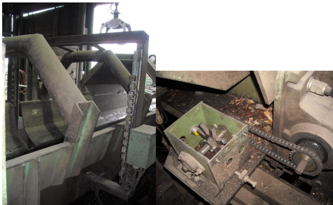
Snímání délky pomocí impulsního generátoru (IRC) a fotobuňky (snímací rám).
