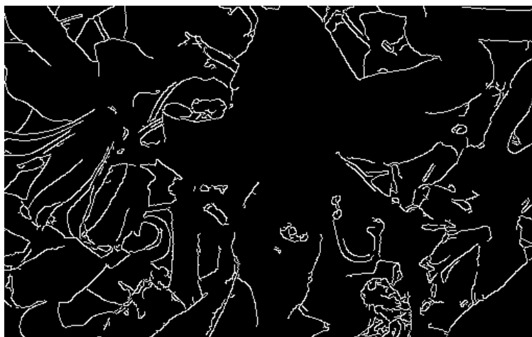
Obrázek 2.24: Cannyho hranový detektor s minimální prahovou hodnotou 60
