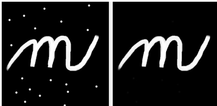
Obrázek 2.30: Otevření, vlevo: původní obrázek zatížený šumem, vpravo: obrázek po otevření (velikost jádra: 9)
