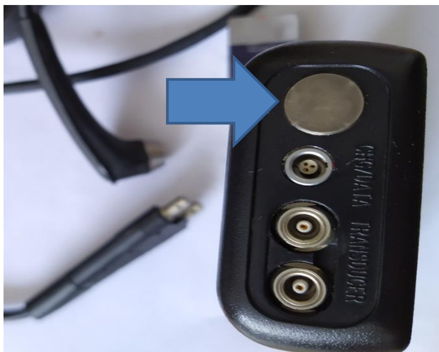
Obrázek 41 – Kalibrace sondy ultrazvukového tloušťkoměru
