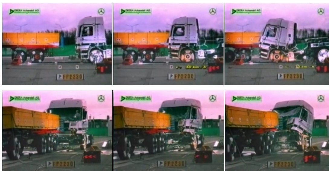
Obr. 54 až 59: Crash test najetí zezadu – sekvence snímků
