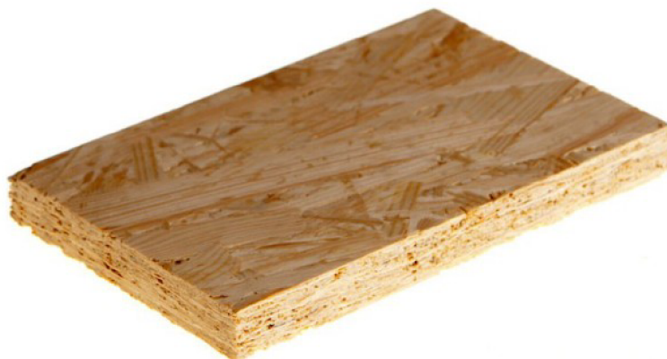
Obrázek 20: Deska z orientovaných plochých třísek (Böhm, 2012)
