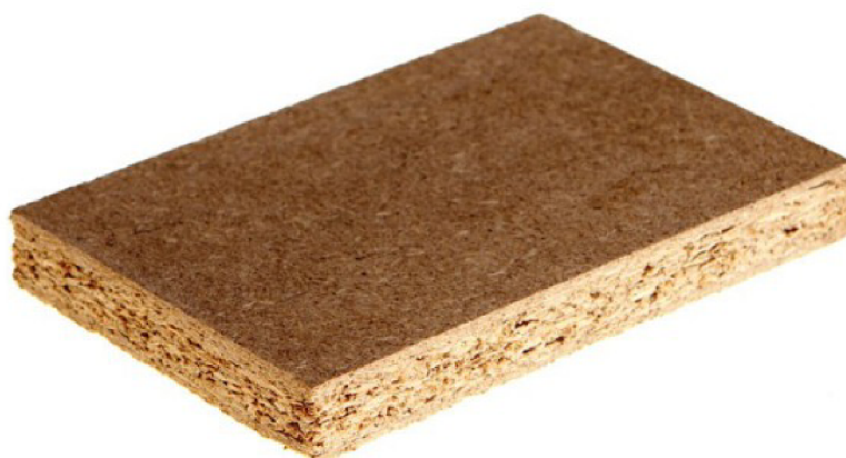
Obrázek 21: Dřevotřísková deska (Böhm, 2012)
