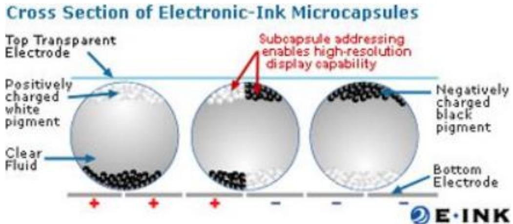
Obrázek 5 Princip funkce elektronické inkoustové kapsle [11]
