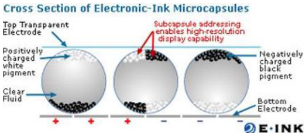
Obrázek 5 Princip funkce elektronické inkoustové kapsle [11]
