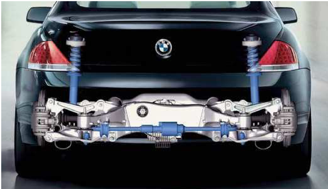
Obr. 3.6 Systém Dynamic Drive s aktivními stabilizátory [10]
