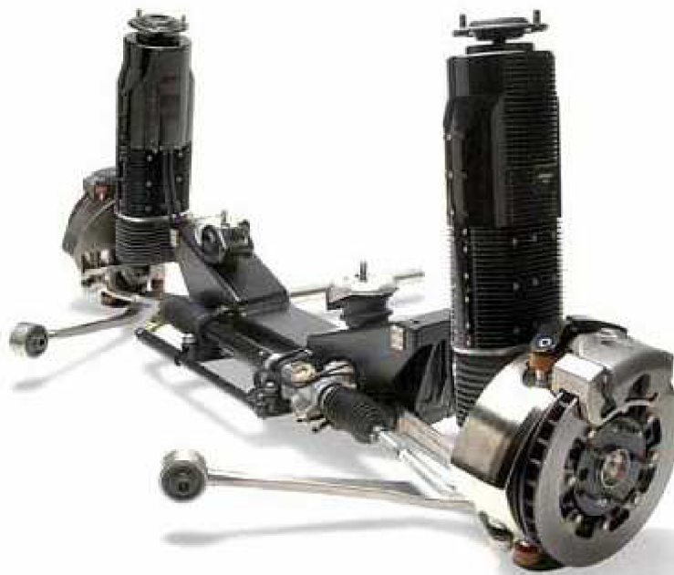
Obr. 3.8 Náprava s lineárními elektromotory MRC Bose [8]
