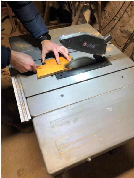
Obr. 21. Řezání na stolní pile
