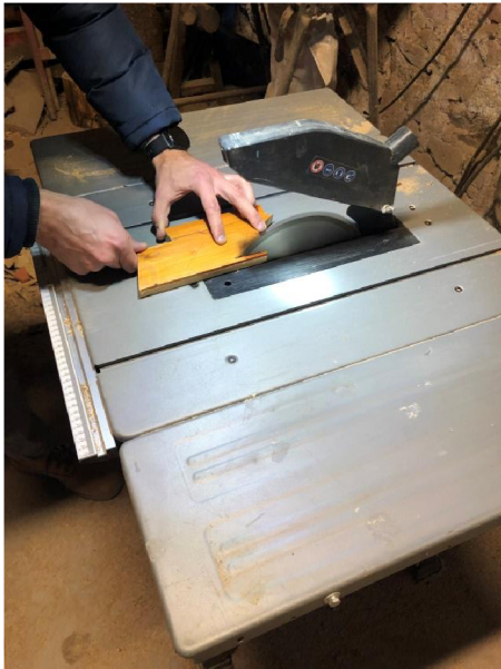
Obr. 21. Řezání na stolní pile
