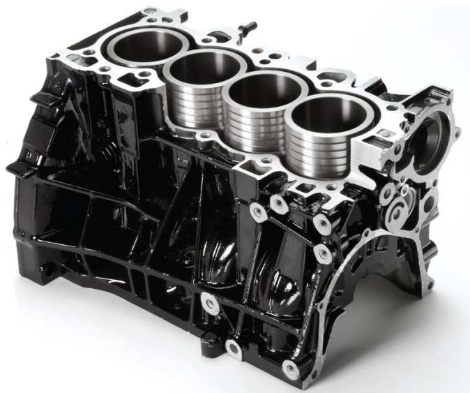
Obr. 9 Koncepce se spojenými pouzdra válců s otevřeným prostorem pro chlazení [6]
