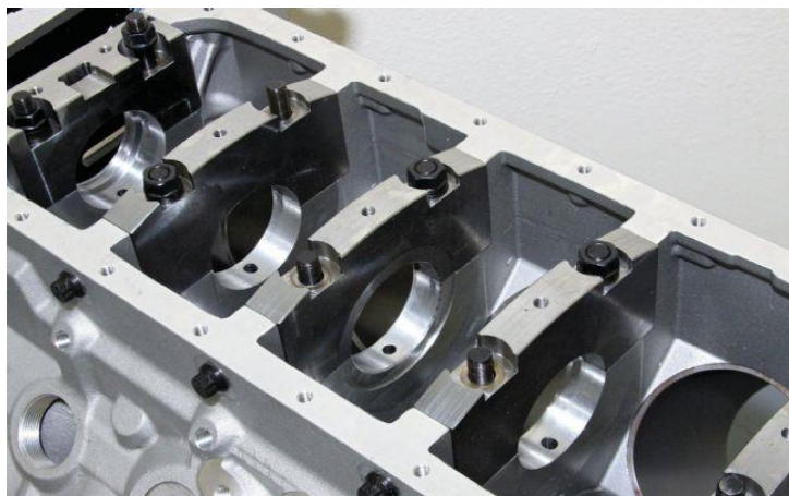
Obr. 21 Uchycení klikového hřídele - „X-bolting“ [14]
