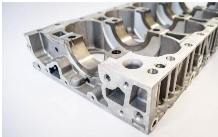
Obr. 24 Spodní kliková skříň s integrovanými litinovými víky ložisek [13]
