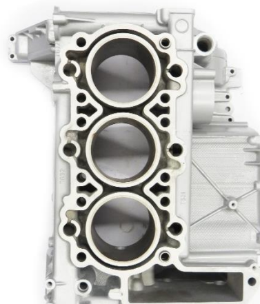
Obr. 11 Konepce s jednotlivými vložky válců [7]
