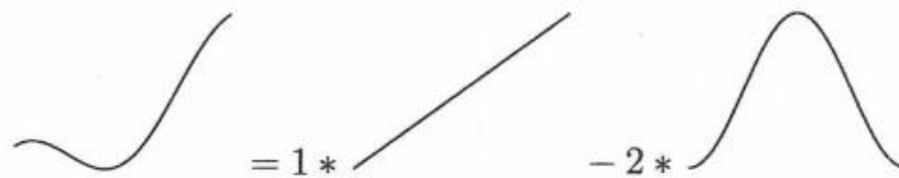
Obr. 62 Deformace a její aproximace součtem tvarů tělesa [18]
