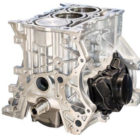
Obr. 26 Zážehový tříválcový motor 1.0 MPI koncernu Volkswagen [15]
