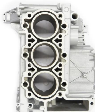
Obr. 11 Konepce s jednotlivými vložky válců [7]
