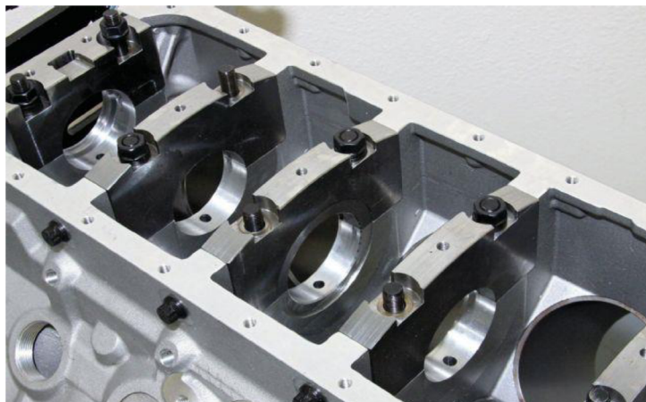
Obr. 21 Uchycení klikového hřídele - „X-bolting“ [14]
