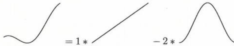
Obr. 62 Deformace a její aproximace součtem tvarů tělesa [18]
