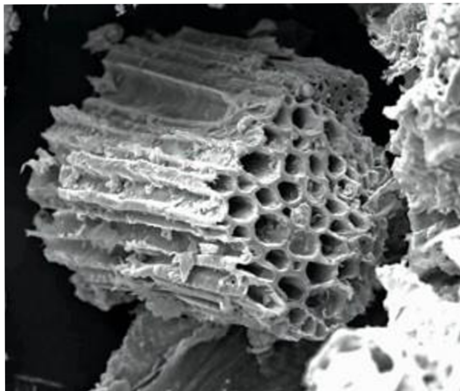
Obr. 2.12 - Snímek SEM kukuřičného biouhlu vyrobeného při 350°C [36]
