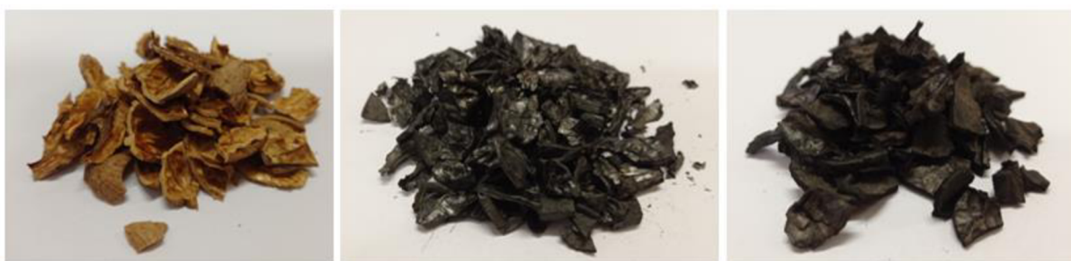
Obr. 3.1 - Ořechové skořápky před pyrolýzou (vlevo), po pyrolýze 400°C (uprostřed), po pyrolýze 700°C (vpravo)
