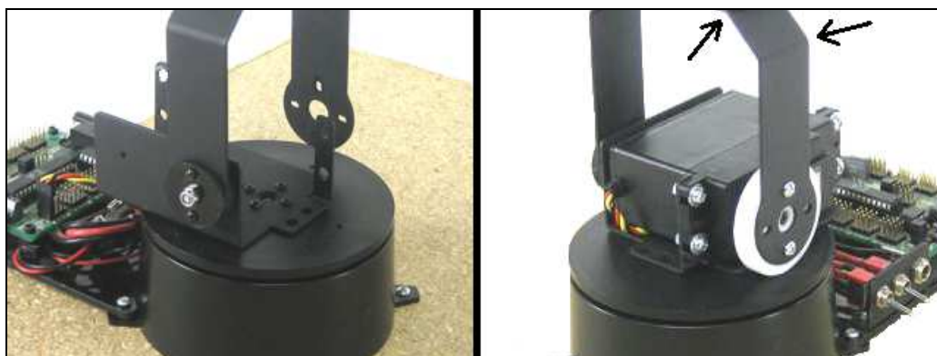
Obrázek 32 Ramenní kloub a připojení paže [9]
