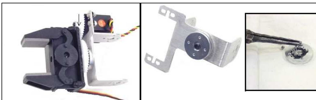
Obrázek 35 Rotace zápěstí a chapadlo [9]
