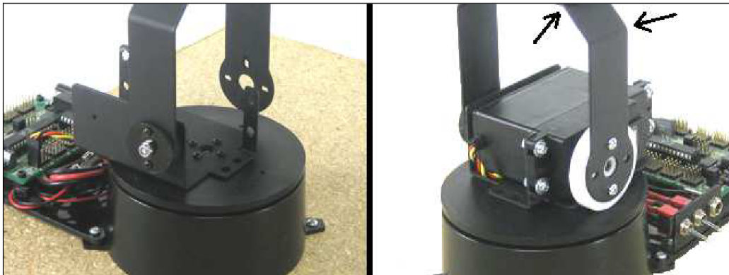
Obrázek 32 Ramenní kloub a připojení paže [9]
