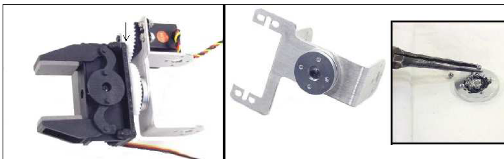
Obrázek 35 Rotace zápěstí a chapadlo [9]
