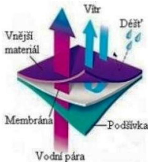
Obrázek 8: Schéma třívrstvého laminátu [11]
