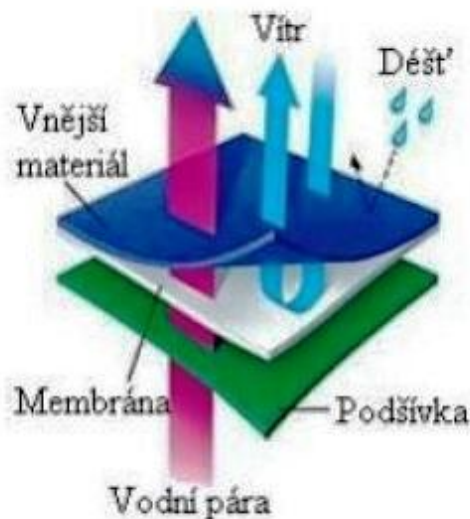
Obrázek 5: Schéma dvouvrstvého laminátu s volně vloženou podšívkou [13]
