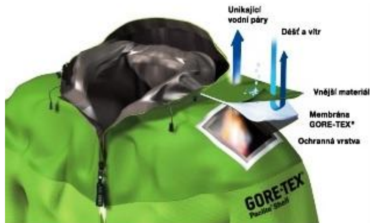
Obrázek 7: Princip laminátu Gore-Tex Paclite [16]
