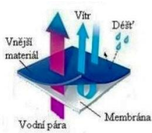
Obrázek 4: Schéma dvouvrstvého laminátu [13]
