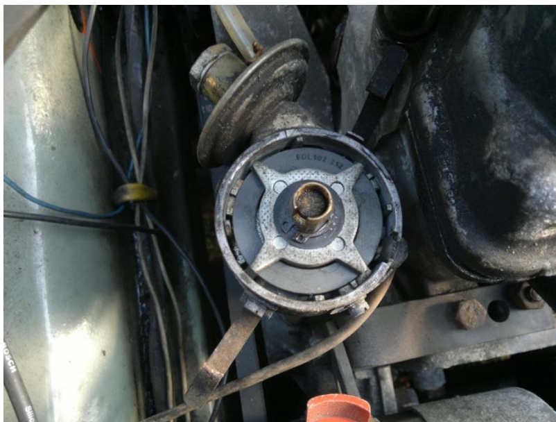
Obrázek 1.1 Elektronické zapalování s mechanickým regulátorem předstihu
