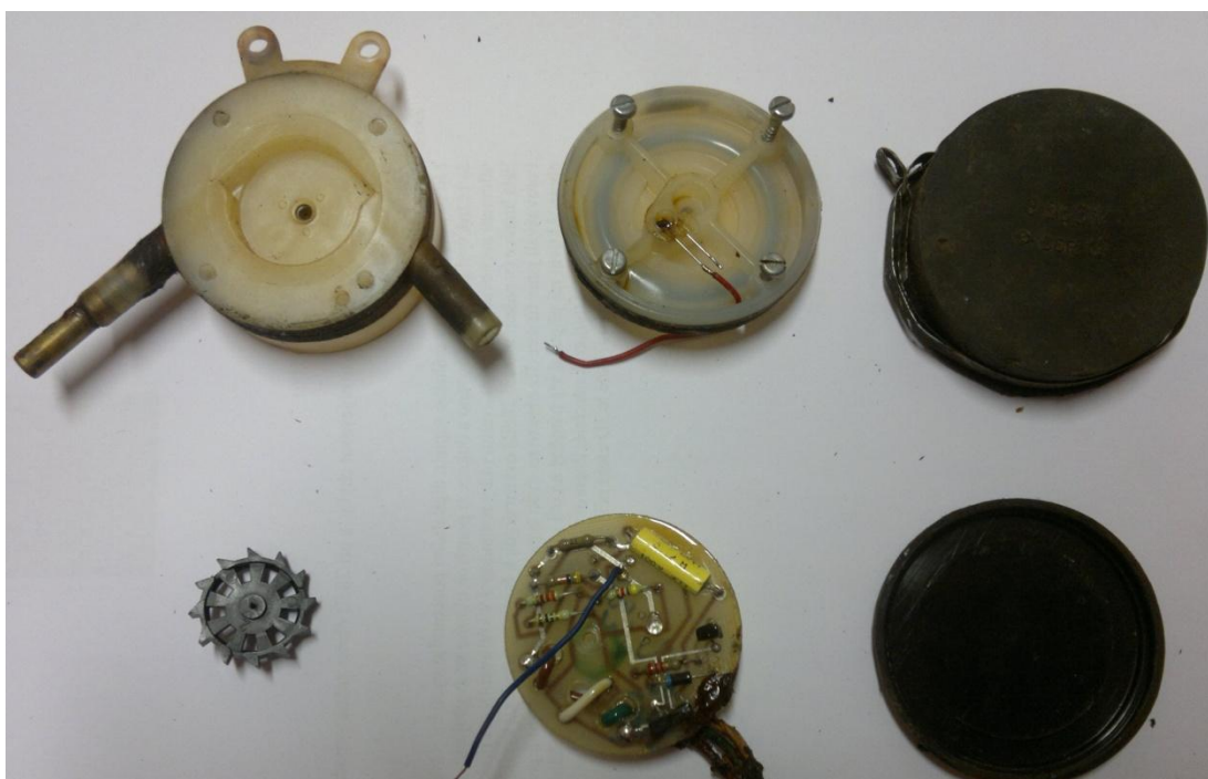
Obrázek 2.5 Demontovaný originální průtokoměr z roku 1985
